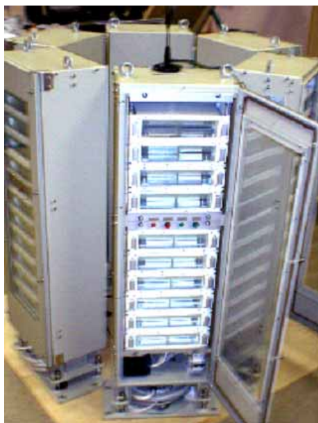
Рис. 7. Светооптическое устройство маяка СОУ-М
